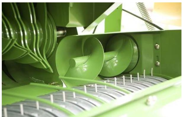
Optimizovan dizajn je omogućio i optimalan protok – **EasyFlow** PickUp formira kompaktnu jedinicu sa rotorom koji puni komoru za baliranje. Zazor između rotora i komore je povećan, a rotor je odmah iza PickUp-a, pa je na ovaj način povećan usisni kapacitet i obezbeđen konstantan protok materije. Eliminisan je rizik od neravnomernog ulaska. Materija se kreće ravnomođno, glatko i konzistentno kroz komoru.
